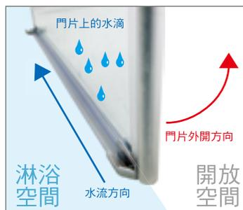
門片開啟，門片上的水滑落到導水條溝槽內。
