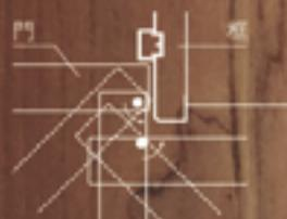
平坦翼型設計不會突出門框。雙樞軸旋轉系統能夠180度敞開。
